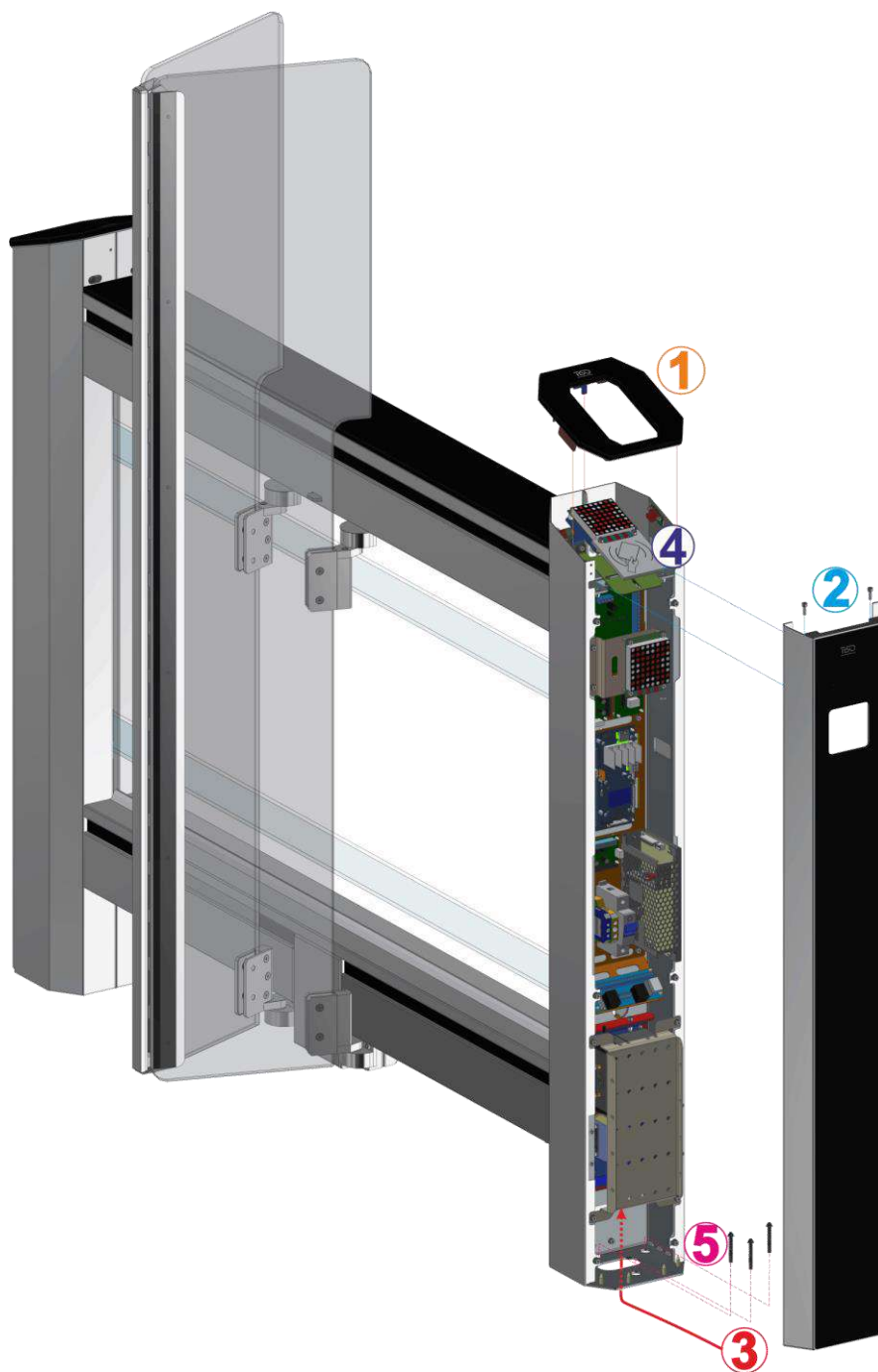
Рис.17 - Загальний вигляд встановлення тумби турнікета «Slide-1»
